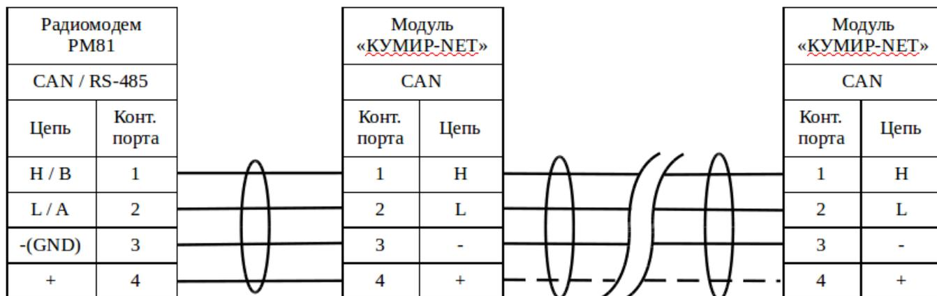
Рисунок 4 – Подключение по интерфейсу CAN
